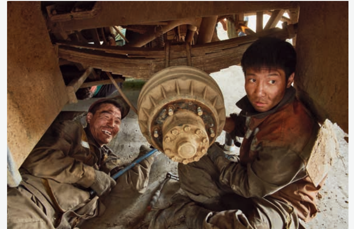
Zwei Autoschlosser reparieren in der zentralen Buswerkstadt von Ulaanbaatar die Blattfedern an unserem Bus. (oben) Der zunehmende Autoverkehr hat seinen Preis: eine Glocke aus Staub und Smog liegt über der Ausfallstraße in Ulaanbaatar. (links)
